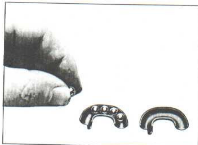
Fig. 3B-13--Filling Ball Guides--Corvette
